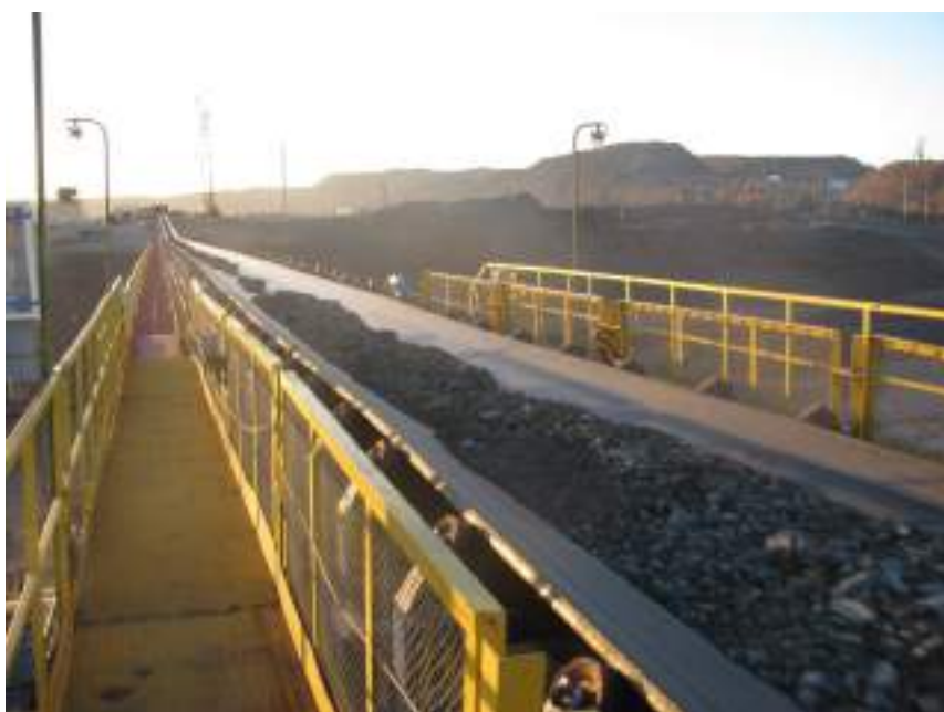
Рис. 1. Дополнительная рекомендуемая конвейерная эстакада для транспортирования породы через комплекс ЦПТ-руда с КНК
