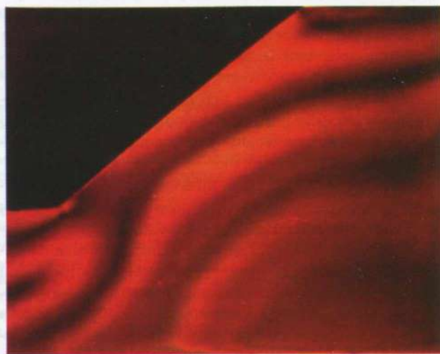
Рис. 2. Изохроматическая картина напряжений при плоской конфигурации профиля борта разреза.
