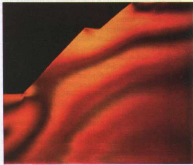
Рис. 6. Картина полос и деформаций при ступенчатом профиле борта разреза.
