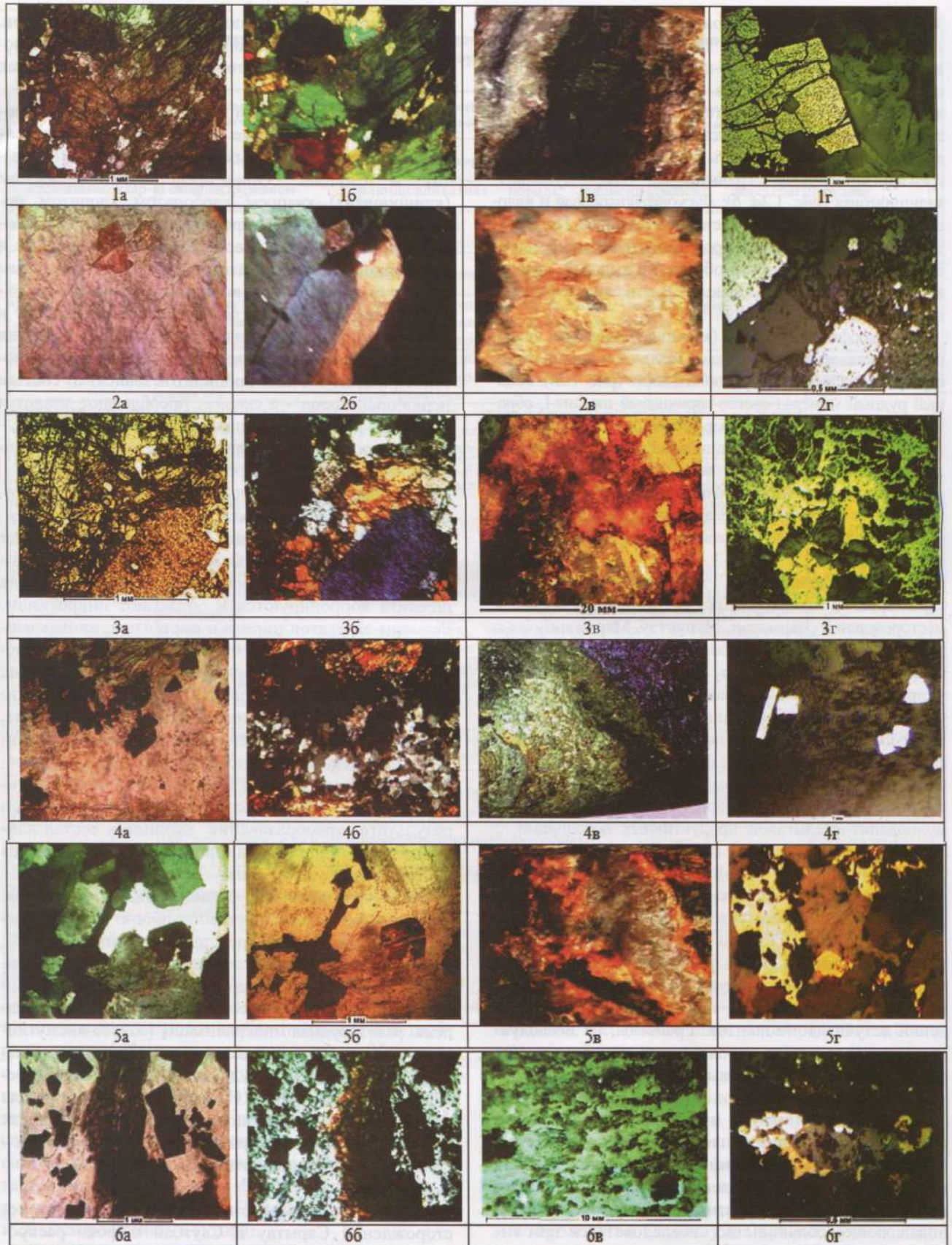
Рис. 1. Текстурно-структурные особенности (в проходящем свете: а-николи параллельны; б-николи скрещены), внешний вид (е) и характер размещения рудной минерализации (z) в кварц-геденбергитовых (1), кварц-полевошпатовых (2), пропилитовых (3), березит-лиственитовых (4), эйситовых (5) и аргиллизитовых (6) метасоматитов.
