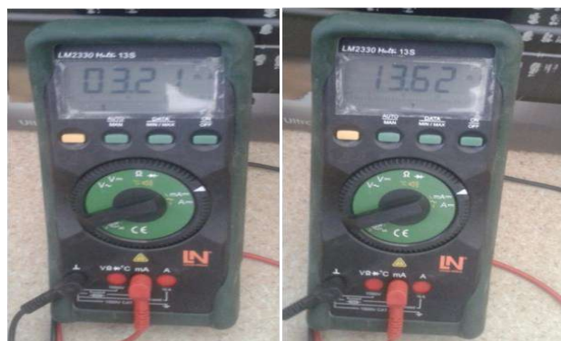
Рис. 4. Показание амперметра с изменением числа проводимых тросов РТЛ.
