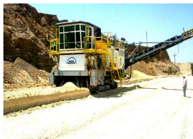
Рис. 4. Послойная выемка фосфоритов комбайном MAN TAKRAF «MTS-250»
