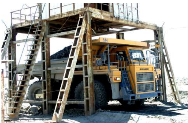
Рис. 1. Рентгенорадиометрическое опробование порции горнорудной массы в кузове автосамовала рудоконтрольной станции (РКС) месторождения Кокпатас.
