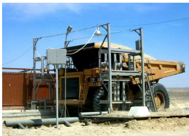
Рис. 3. Радиометрическое опробование порции фосфоритов в кузове автосамосвала на рудоконтрольной станции РКС-Ф
