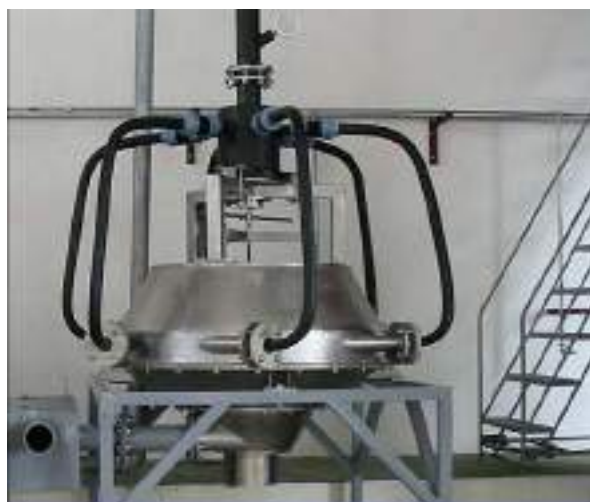
Рис. 2. Общий вид (а) и схема работы (б) флотационной машины Imhoflot
