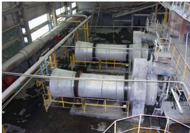
Рис. 13. Горизонтально вращающаяся трубчатая печь для варки жидкого стекла
