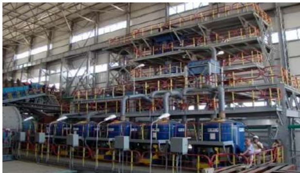
Рис. 3. Отделение измельчения и гравитации ГМЗ-4, концентратор FALCON-SB-5200
