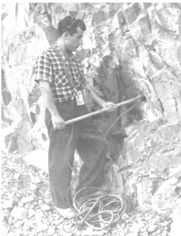
Рис 2. Определение содержания полезного компонента в массиве
