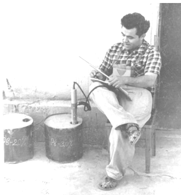
Рис 1. Контроль работы прибора на эталонных пробах при гамма-гамма методе опробования при радиометрическом опробовании
