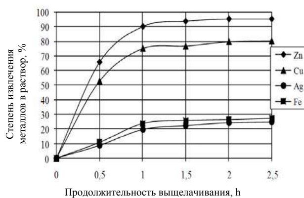
Рис.2. Зависимость степени извлечения металлов в раствор от продолжительности выщелачивания
