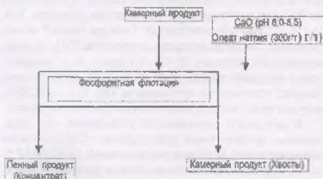
Рис. 2. Схема фосфоритовой флотации камерного продукта (концентрата) карбонатной флотации.
