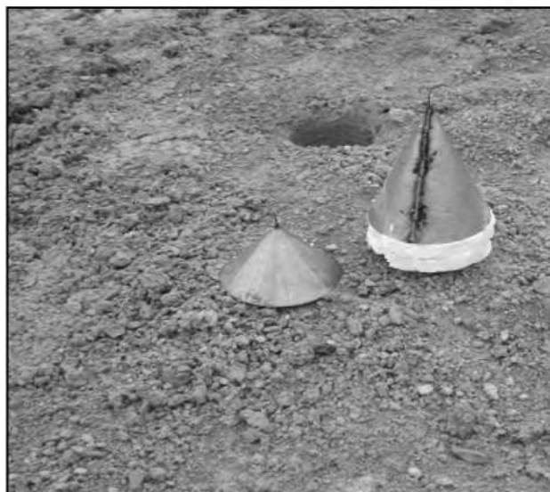
Рис. 5. Кумулятивная воронка из металлической облицовки.
