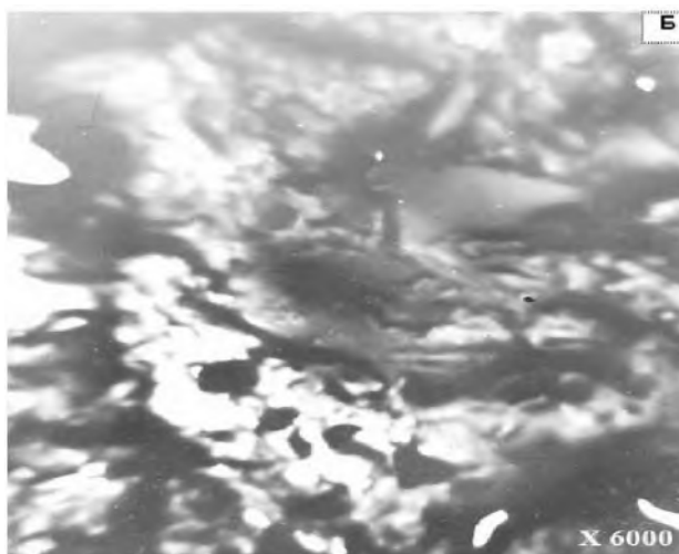
Рис. 3. Заполнение порового пространства гидратирующей системы кристаллами этtringита и ферриэтtringита (А) с формированием структуры сульфокompозита к 28 сут твердения (Б).
