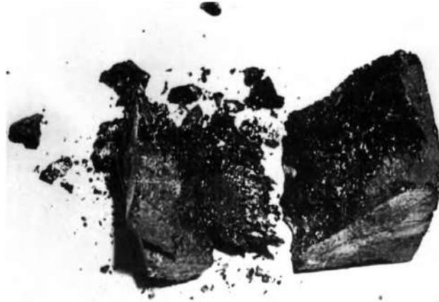
Рис. 3. Разрушение образца сдвигом (разрушение при «обобщенном» сдвиге).
