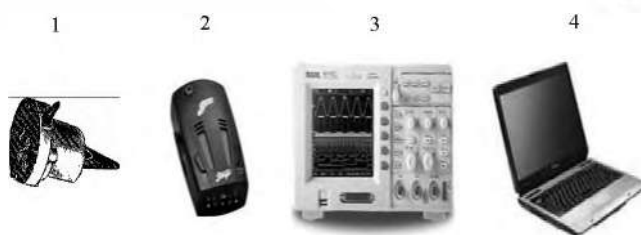
Рис. 10. Схема регистрации импульсного сигнала при взрыве в массиве разнопрочных горных пород: 1 – датчик регистрации импульсного сигнала; 2 – усилитель импульсного сигнала; 3 – электронный осциллограф; 4 – персональный компьютер для обработки данных.
