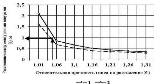
Рис. 4. Графики изменения расстояния (а) между контурными шпурами, наполненными НРС, от относительной прочности гипса ( \sigma_p ): 1 - при одной вставке и 2 - при двух параллельных вставках; значение (а) для условий Новомосковского гипсового месторождения.
