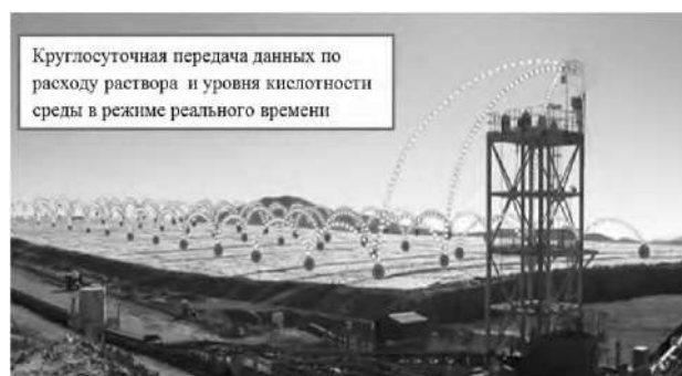
Рис. 3. Схема передачи сигнала беспроводной установка Smart Wireless.
