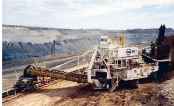
Рис. 3. Мобильная дробильная станция MS-1 компании MMD производительностью 10 тыс. т/ч на разрезе «Goonyella» (Австралия) с погрузкой горной массы экскаватором марки P&H2800
