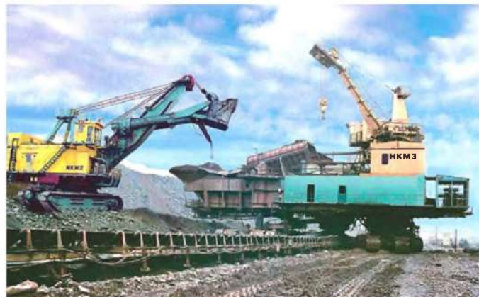
Рис. 2. Самоходный дробильно-перегрузочный агрегат ДПА-2000 производства ПАО «Новокраматорский машиностроительный завод (НКМЗ) на опытно-промышленном участке Центрального ГОКа (Кривбасс)
