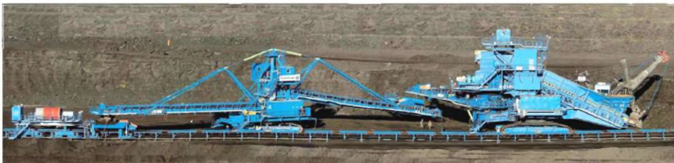
Рис. 5. Технологический комплекс «Экскаватор – мобильная дробилка – ленточный перегружатель – ленточный конвейер»
