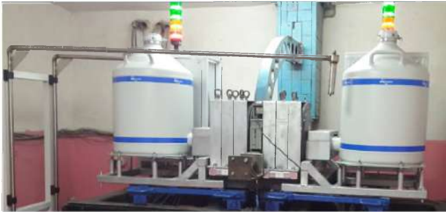
Рис. 4. Внешний вид измерительной части комплекса с системой детектирования на основе детекторов из особо чистого германия GCD-45180
