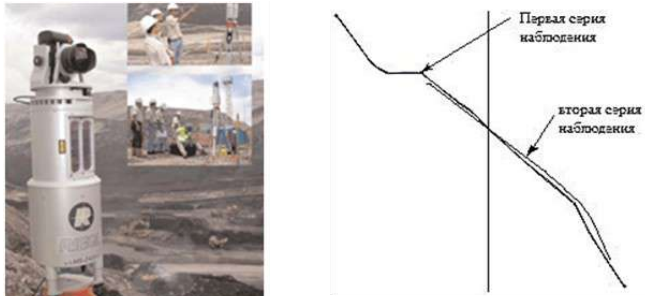
Рис.1. Лазерный сканер и схема деформирования массива
