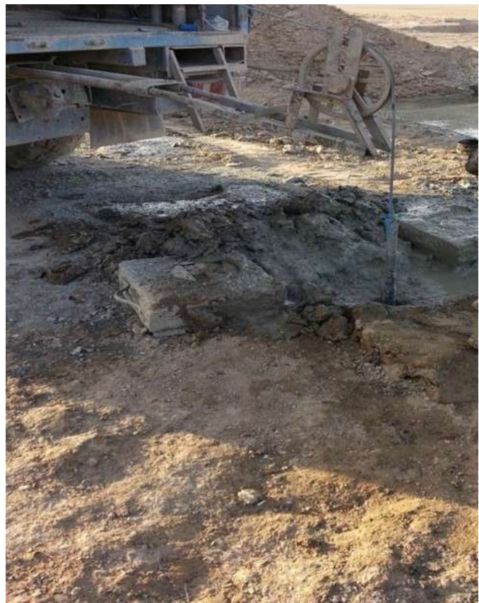
Рис. 1. Геофизическое исследование геологоразведочной скважины в процессе изучения комплексного каротажа
