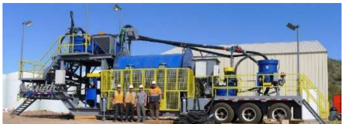
Рис. 5. Мобильный модуль «измельчение-классификация-гравитация» производства Sergio на месторождении в США
