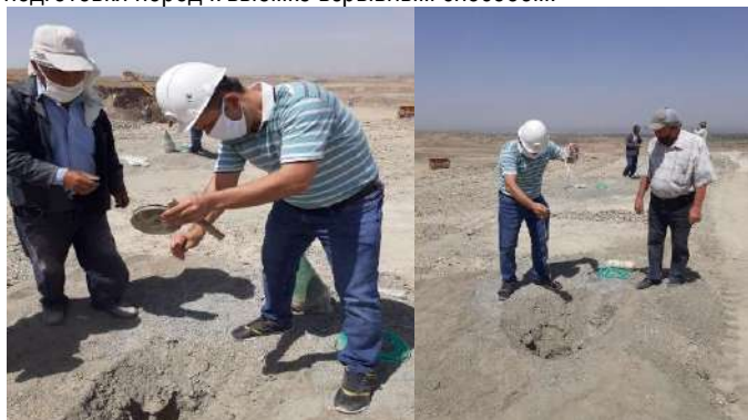
Рис. 3. Измерение глубины скважин глубиномером
