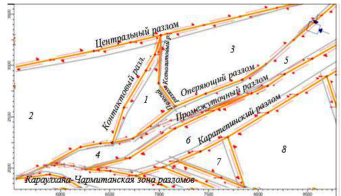
Рис. 3. Схема разломов района месторождения Чармитан (рудник Зармитан) с указанием направлений скольжения границ тектонических блоков
