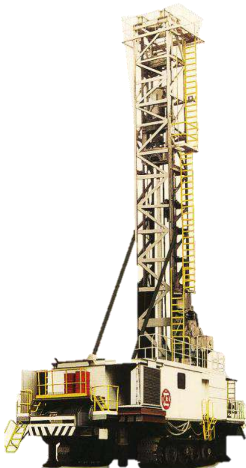
Рис. 1. Карьерный буровой станок 4СБШ – 200 – 40 с ВПМ патронного типа
