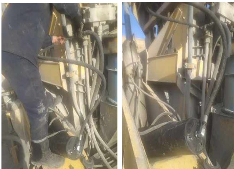
5-rasm. SBSH-250MNA-32 burg'ilash dastgohi uzatishini takomillashtirilgan tsilindrlari magistrallarga pnevmogidravlik akkumulyatorlarni o'lanishi
