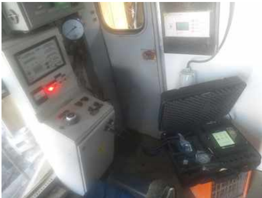
7-rasm. Sinov vaqtida mashinist kabinasida nazorat-o'lchov apparatlarini joylashuvi va o'lchov natijalari
