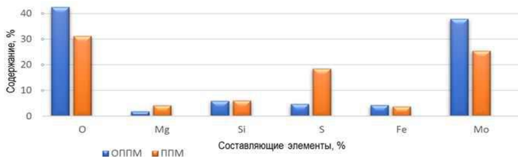
Рис. 7. Изменение структуры молибденового промпродукта при окислительном обжиге
