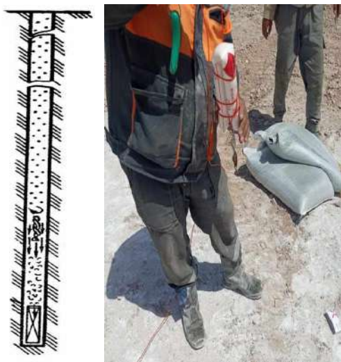
Рис. 2. Расположение турбулизатора в скважине
