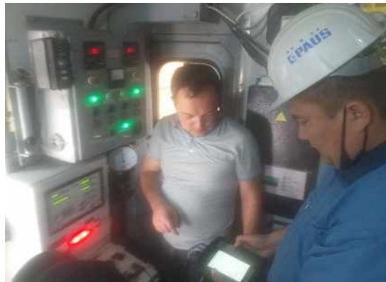
7-rasm. Sinov vaqtida mashinist kabinasida nazorat-o'lchov apparatlarini joylashuvi va o'lchov natijalari
