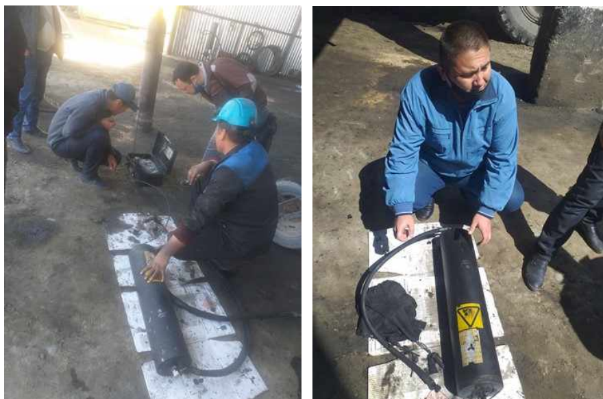
4-rasm. Pnevmodravlik akkumulyatorlarni azot bilan to'ldirish va bosimini nazorat qilish
