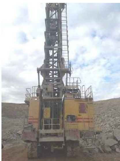
1-rasm. SBSH-250MNA-32 burg'ilash dastgohi elektrogidromexanikli aylantiruvchi-uzatuvchi mexanizmi
