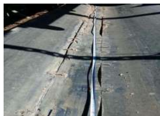
Рис. 3. Поперечные (а) и продольные (б) порывы конвейерных лент
