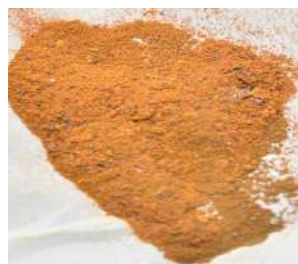
Рис. 6. Вид части расплавленной, испаренной и кристаллизованной на поверхности серы и мышьяка в соединении с окислами железа после 90 мин обработки ВЧ ЭМВ руды «Кокпатас»
