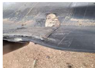
Рис. 3. Поперечные (а) и продольные (б) порывы конвейерных лент
