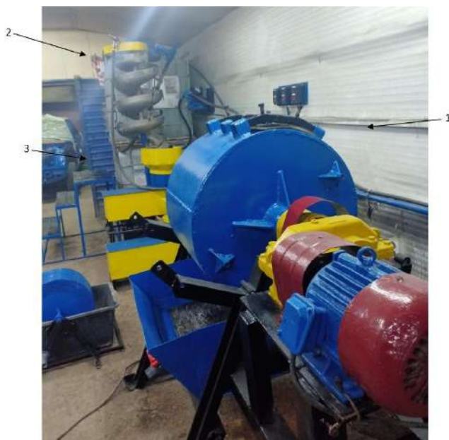
Рис. 5. Установка Carla по обработке геологических проб: 1 – мельница самоизмельчения; 2 – винтовой сепаратор; 3 – центробежные чашевые аппараты
