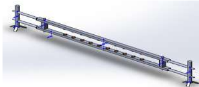
Рис. 8. Дефектоскоп: 1 – опора; 2 – центровка конвейерной ленты; 3 – опора изменяющего расстояния; 4 – ультразвуковые датчики
