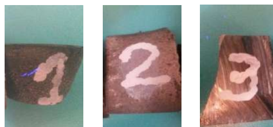
Рис. 2. Образцы белых износостойких чугунов: 1 – 280X29НЛ; 2 – 300X32Н2М2ТЛ; 3 – 330X17Л
