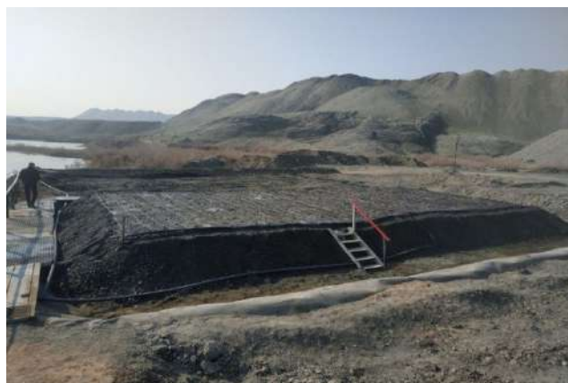
Рис. 1. Опытно-промышленные работы по КВ ЧС руд в ГТР месторождения Учкудук
