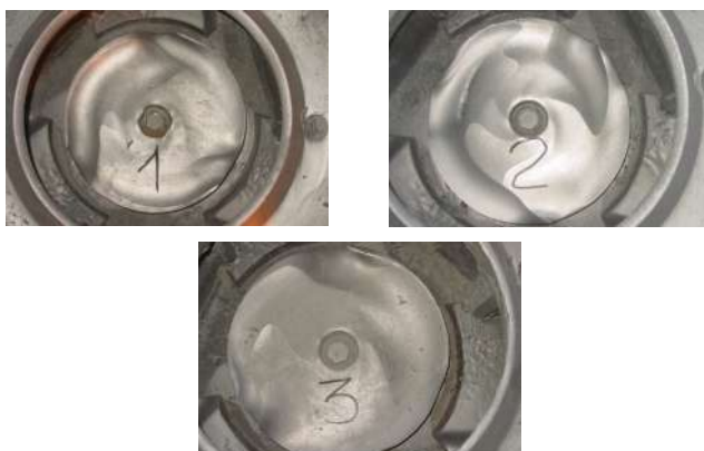
Рис. 4. Внешний вид после эксплуатации питающих дисков
