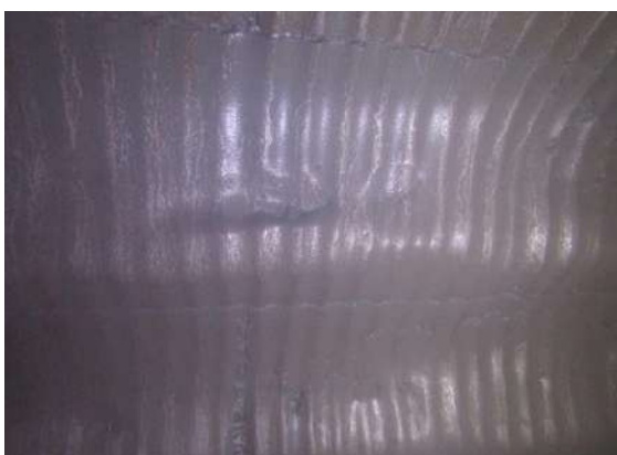
Рис. 3 Вид отработанной усовершенствованной футеровки
