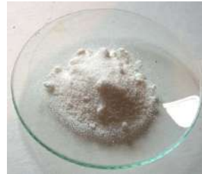
Рис. 4. Осадок парамолибдата аммония, полученного в результате перекристаллизации ( [(NH_4)_6Mo_7O_{24} \cdot 4H_2O] = 98,2\% )
