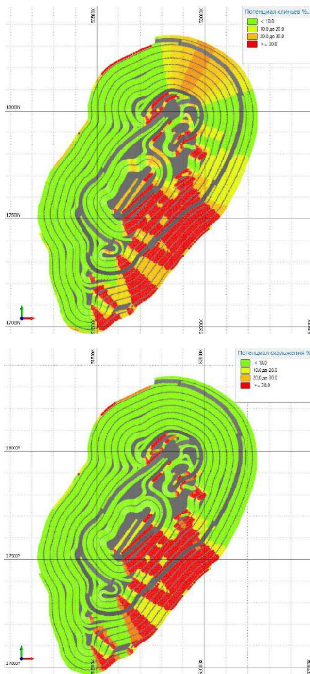
Рис. 2. Участки карьера, склонные к деформационным проявлениям (красный – деформация уступа максимальна, зелёный – деформация уступа минимальна, серый – горизонтальные участки карьера, съезды); а – клиновидное обрушение (WS); б – плоское скольжение (PS)
