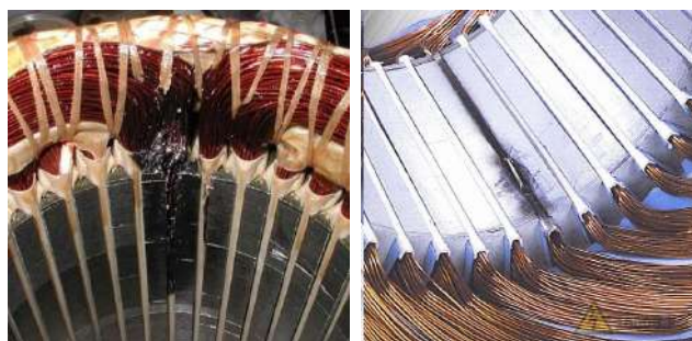
8-rasm. Stator chulg'am izolyatsiyasining shkastlangan qismlarning ko'rinishi
