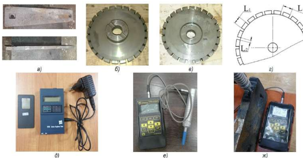
Рис. 2. Фотографии заготовки, фрезы трения и приборов для измерения показателей качества обработанной поверхности: а – образцы из стали 110Г13Л; б, в – фреза трения, вид сверху (а), вид снизу (б); г – эскиз фрезы трения с указанием геометрии; д – прибор TR100 для измерения шероховатости; е, ж – твердомер ультразвуковой ТКМ 459М; L1 – зона нагрева; L2 – зона охлаждения; L – шаг зоны
