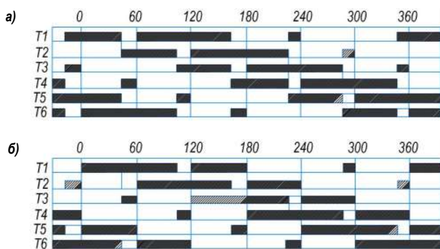
Рис. 2. Диаграммы состояний силовых тиристоров при алгоритмах с введенными дополнительными интервалами проводимости силовых тиристоров, последовательность интервалов: а) \alpha^\circ , 60^\circ + \alpha^\circ ; б) 60^\circ + \alpha^\circ , \alpha^\circ
