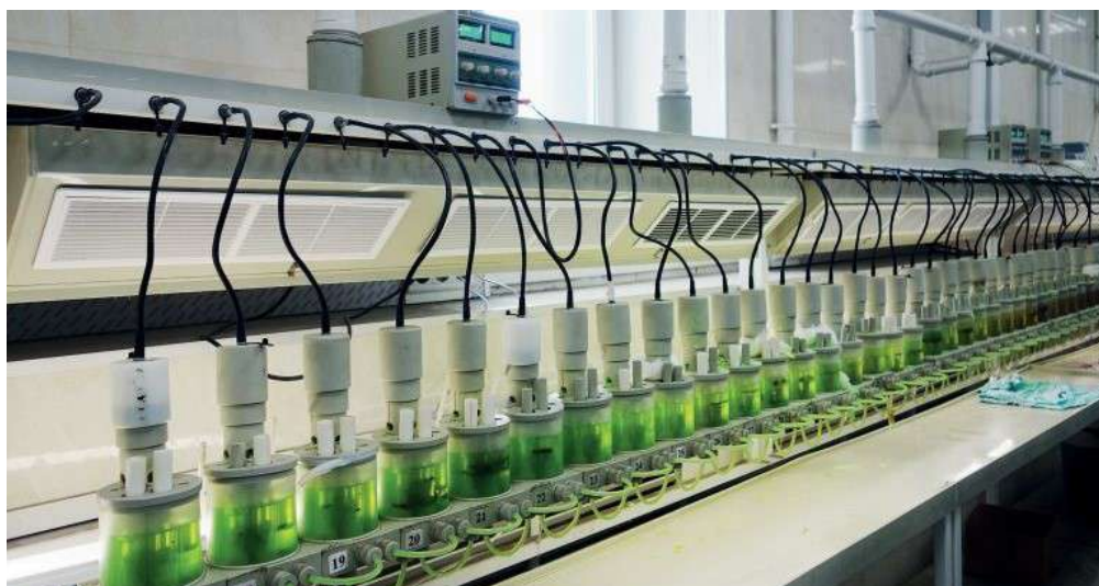
Рис. 2. Лабораторная экстракционная установка непрерывного действия
