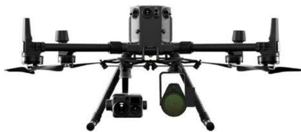
Рис. 2. Комбинированное размещение на БПЛА гибридной камеры и газоанализатора [19]
