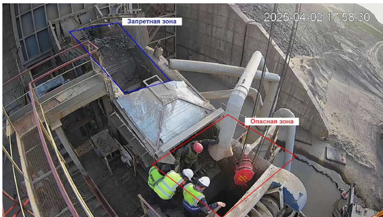
Рис. 2. Система видеоаналитики для определения опасных и запретных зон на производстве
