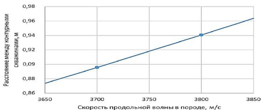
Рис. 13. Влияние скорости продольной волны в горной породе на изменение расстояния между контурными скважинами
