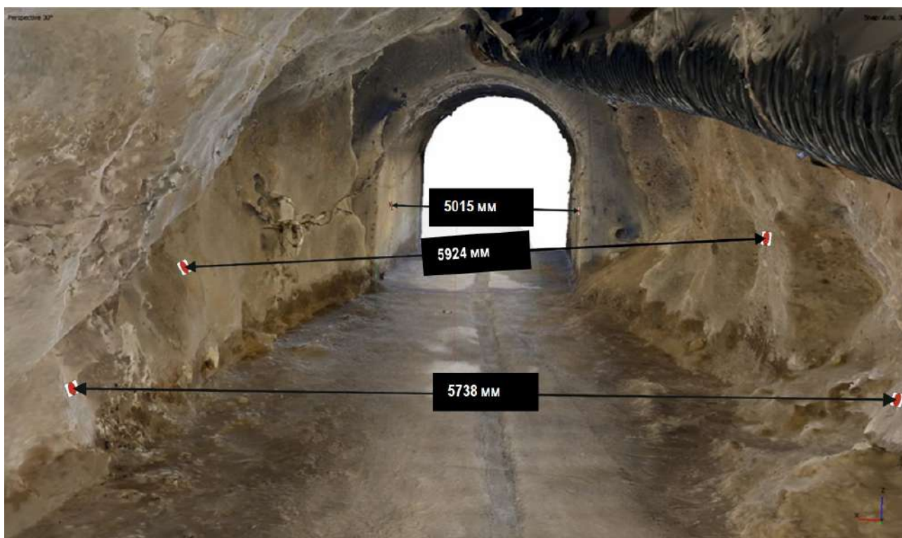
Рис. 7. Проверка пространственного соответствия модели по опорным точкам
