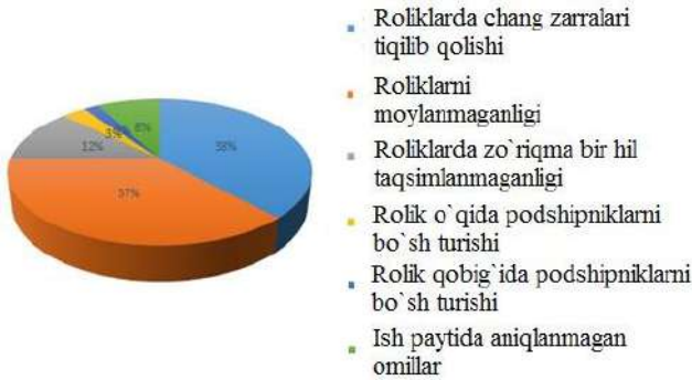
3-rasm. Roliklarning ishlamay qolish sabablari
