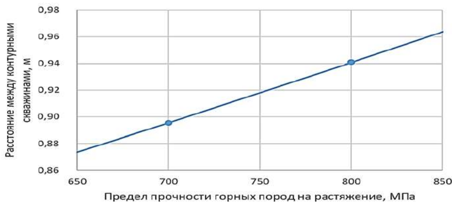
Рис. 17. Влияние предела прочности горных пород на растяжение на изменение расстояния между контурными скважинами
