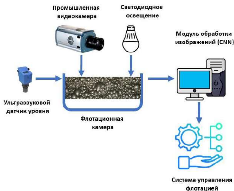
Рис. 1. Структурная схема системы видеоаналитики процесса флотации.
