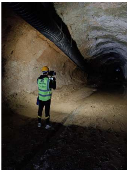
Рис. 4. Полевая реализация фотограмметрической съемки
