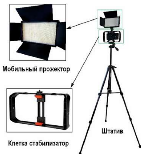
Рис. 2. Конструкция для фотографирования в подземных условиях
