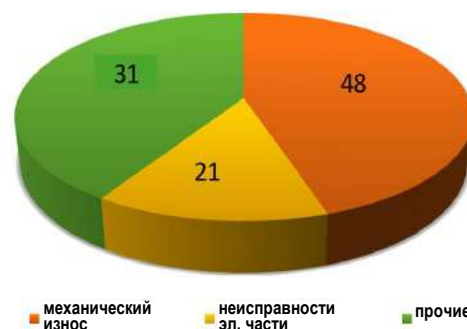
Рис. 1. Причины отказов насосного глубинного оборудования
