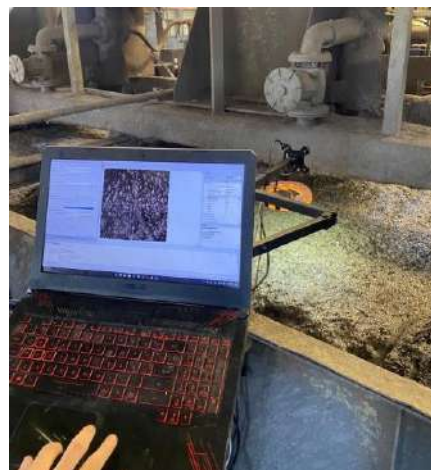
Рис. 3. Пример работы системы видеоаналитики процесса флотации на горнодобывающем предприятии Compagnie Minière des Guemassa (CMG), Марокко
