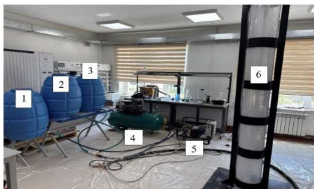
Рис. 2. Общий вид лабораторной установки для приготовления пеногеля: 1, 2, 3 – емкости под реагенты; 4 – компрессор; 5 – установка «Пена-3000/10УМ»; 6 – модель скважины
