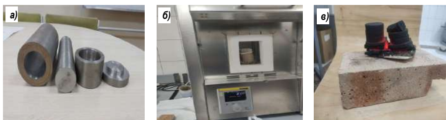
Рис. 2. Общий вид: а – пресс-форма; б – электропечь муфельная (до 1500 °С); в – образцы после обжига при температуре 1420 °С
