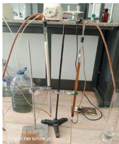
Рис. 4. Схема лабораторной установки для проведения исследований по сорбционной очистке от роданидов в динамических условиях
