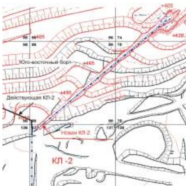
Рис. 3. Строительство новой КЛ-2 на юго-восточном борту карьера Мурунтау
