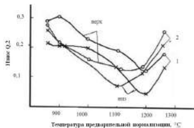
Рис. 2. Изменение величины износа образцов стали 40X в зависимости от температуры и времени предварительной нормализации. Окончательная термическая обработка: индукционная закалка, отпуск 200^{\circ}C : предварительная нормализация 30 мин (1) и 2 часа (2)
