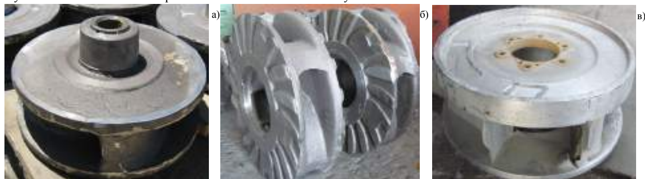
Рис. 1. Чугунные отливки рабочих колес насосов «8Гр» (а), «Warman» (б) и ротора барабана дробилки «СЕМСО» (в)
