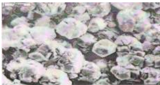
Рис. 3. Электронно-микроскопический снимок кристаллов доломита. Увел. 2000х
