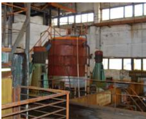
Рис. 2. Реактор для сернокислотного выщелачивания МФ
