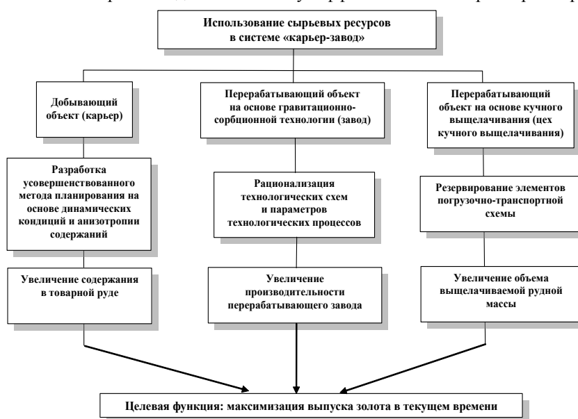
Рис. 1. Рекомендуемая структурная схема повышения эффективности системы «карьер-завод»
