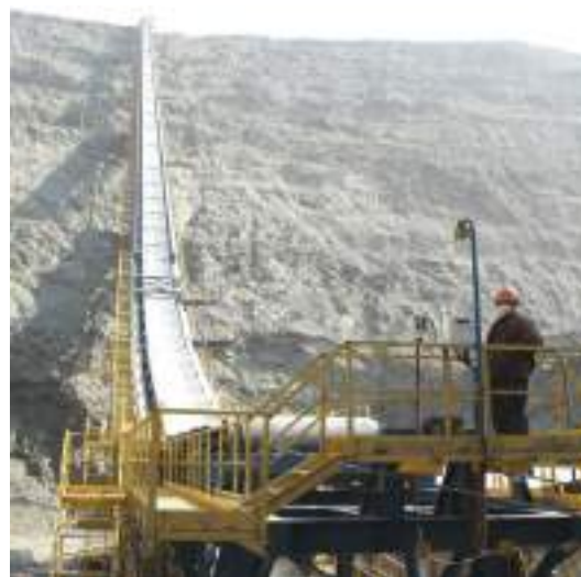
Рис. 3. Крутонаклонный конвейер в карьере Мурунтау
