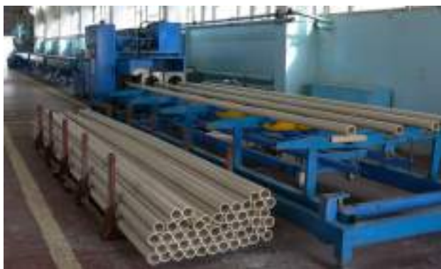
Рис. 2. Линия по изготовлению поливинилхлоридных труб
