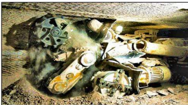
Рис. 3. Проходческо-очистной комбайн «Урал 20 Р» в забое
