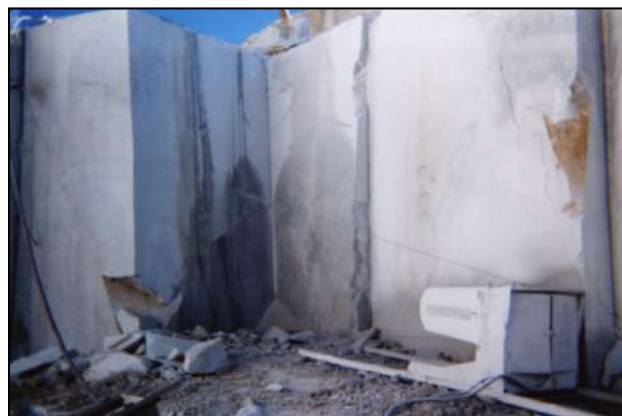
Рис. 4. Технология распиловки высоких мраморных забоев алмазно-тросовыми установками с выпиливанием горизонтального клина
