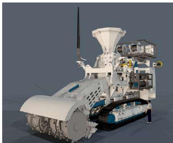
Рис. 6. Самоходное оборудование для разработки глубоководных корок [2]
