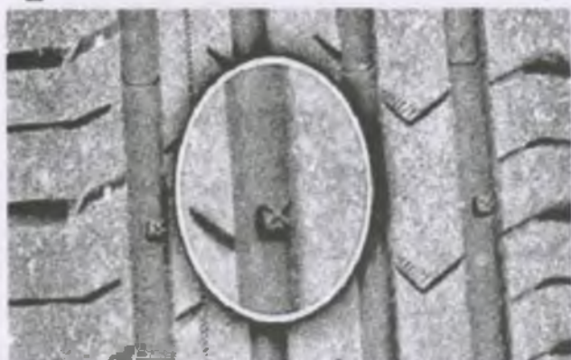
Рис. 1а. Индикатор износа на автошине Continental.
