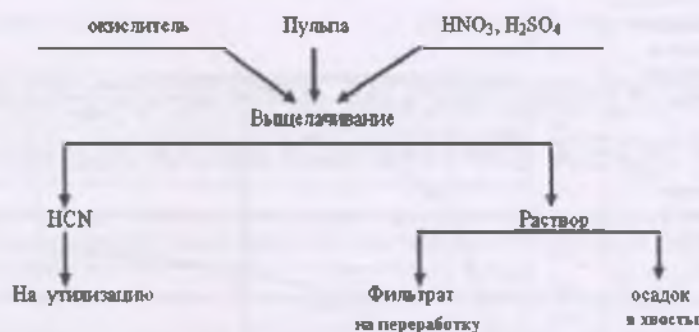
Рис. 5. Предлагаемая схема переработки сбросовых пульп золотоизвлекательных фабрик.
