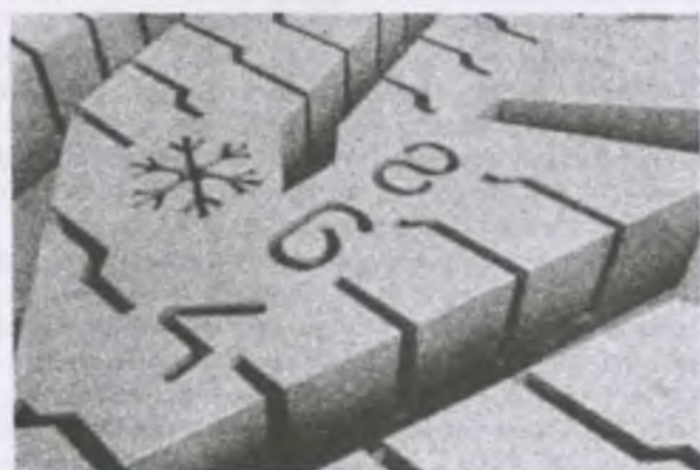
Рис. 1.а. Индикатор износа на автошине Nokian.
