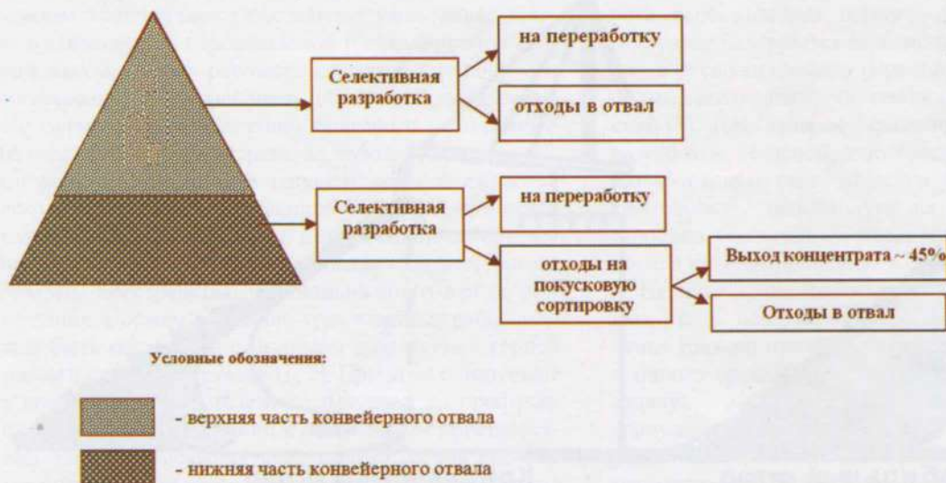
Рис. 2. Технологическая схема разработки высоких конвейерных отвалов.
