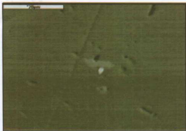
Рис. 1. Самородное золото (ярко белое) в сростке с арсенипиритом (тускло-белый) и серебросодержащим тетраэдритом (светло-серый) находится в пирите. Пирит имеет примесь As~3,4%. Аншлиф КД-5. Проба 169, Дайковый 5.
