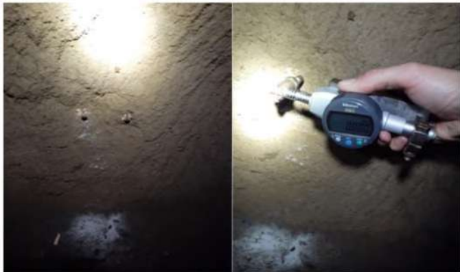
Рис.2. Установка микрометра между реперами с последующим обнулением его показаний
