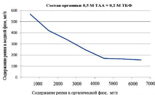
Рис.5. Изотерма экстракции рения при составе органики 0,5М ТАА + 0,2М ТБФ
