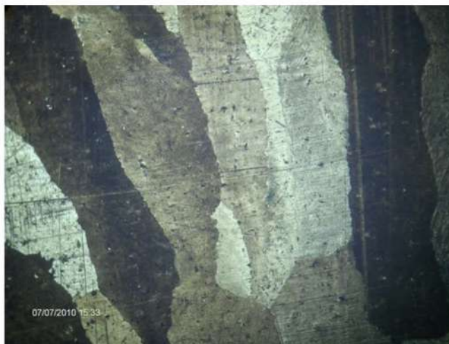
Рис.6. Крупнозернистое строение с явно выраженной столбчатой структурой (x 100)
