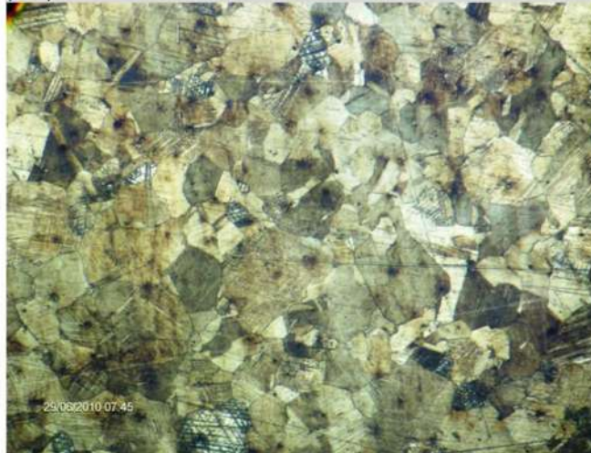
Рис.7. Мелкие зерна аустенита стали 110Г13Л после предварительного отпуска. T_{отп.} = 600^{\circ}C . (x 100)
