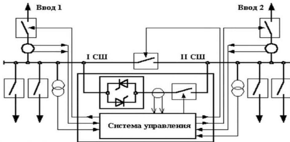
Рис.1. Схема быстродействующего автоматического ввода резерва
