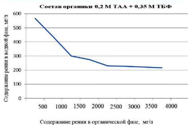
Рис.2. Изотерма экстракции рения при составе органики 0,2М ТАА+ 0,35М ТБФ
