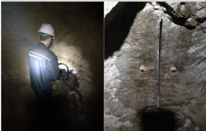
Рис.3. Оборудование с алмазным диском для образования щели
