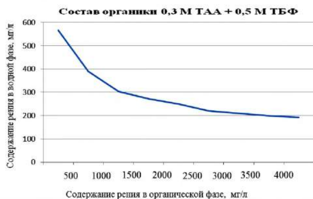
Рис.3. Изотерма экстракции рения при составе органики 0,3М ТАА+ 0,5М ТБФ
