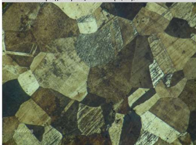
Рис.4. Микрофотография стали 110Г13Л после закалки, T_{зак} = 1100^{\circ}C (x 100)
