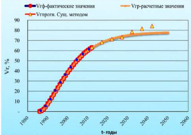
Рис. 4. Зависимость суммарного количества отобранного газа от начальных запасов V_{гг} в % от времени t
