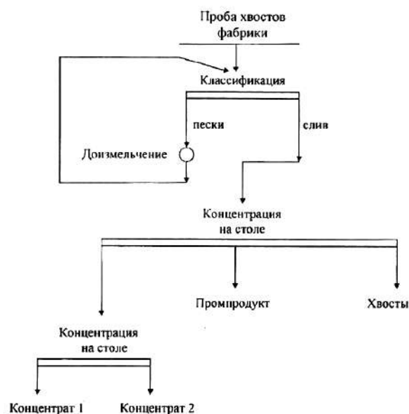
Рис. 2. Схема обогащения хвостов на концентрационном столе
