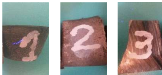
Рис. 1. Образцы белых износостойких чугунов: 1 – 280X29HL, 2 – 300X32H2M2TL, 3 – 330X17L
