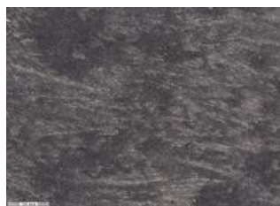
Рис. 3. Структура чугуна 300X32H2M2TL, х 200, х 1000
