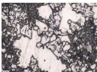
Рис. 3. Структура чугуна 300X32H2M2TL, х 200, х 1000
