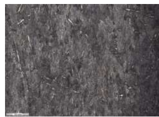
Рис. 5. Структура чугуна 330X17Л, х 200, х 1000
