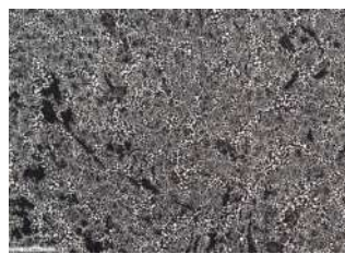
Рис. 5. Структура чугуна 330X17Л, х 200, х 1000
