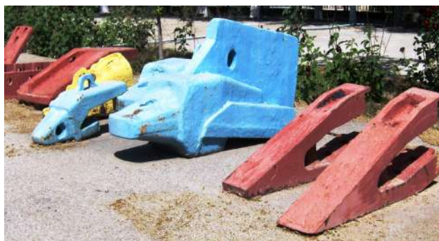
Рис. 1. Отливки из высокомарганцовистой износостойкой стали 110Г13Л
