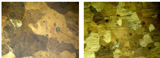
6-rasm. Namunalarning austenizatsiyalangan holatdagi ichki tuzilishi, x100: a – 110G13L markali po'lat ichki tuzilishi; b – 120G17XRL markali po'lat ichki tuzilishi
