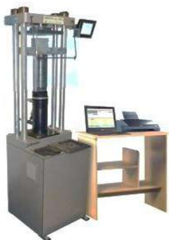
2-rasm. Tog' jinslari namunalarini bir o'q bo'ylab siqilishga sinash uchun qo'llaniladigan jihozning umumiy ko'rinishi (IP-1A-1000 PK modeldagi gidravlik press)
