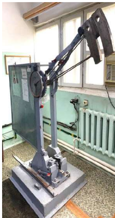
3-rasm. MK-30A rusmli zarbiy qovushqoqlik sinovi uskunasi (a) va sinov namunalari (b)
