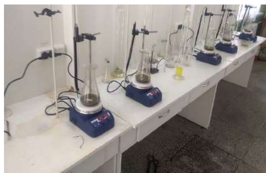
Рис. 2. Переход растворения процесса с соляной кислотой и водой в магнитной мешалке с подогревом
