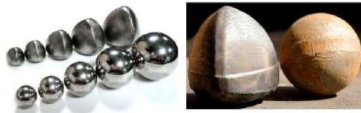
3-Rasm. Yanchish vositalarining yuklanishida: (a) Relo M-1 va boshqa sharlar (b) Relo M2 va boshqa sharlar
