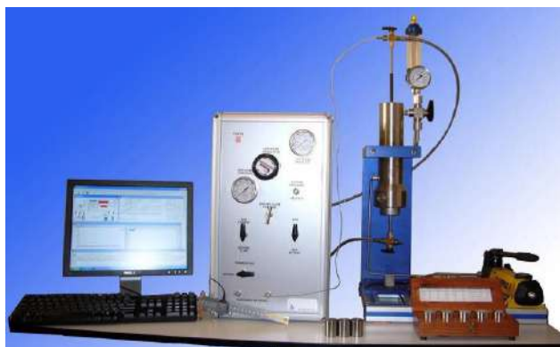
Рис. 2. Газовый порозиметр UltraPoroPerm-500
