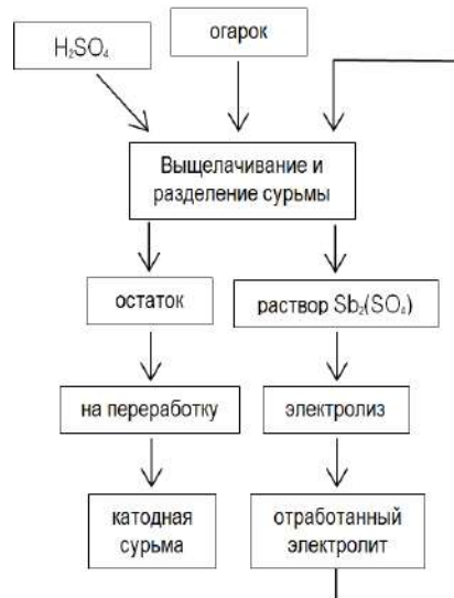
Рис. 4. Принципиальная технологическая схема гидрометаллургического способа переработки огарков содержащих сурьму
