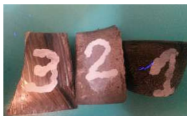
Рис. 3. Образцы белых износостойких чугунов: 1 – 280X29НЛ; 2 – 300X32H2M2ТЛ; 3 – 330X17Л
