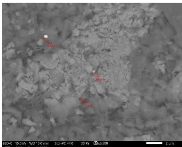
ж) температура 625°C, наночастицы золота размером от 180 нм до 770 нм
