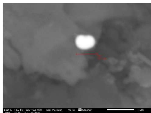
б) температура 500°C, размер частиц около 800 нм, частица золота прикреплена к поверхности сульфата кальция, по данным СЭМ картирования
