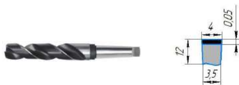
2-rasm. Quvur devorini teshuvchi parma va quvur devorini kesib teshik ochuvchi karonkali planetar keskichning kesuvchi tig'i
