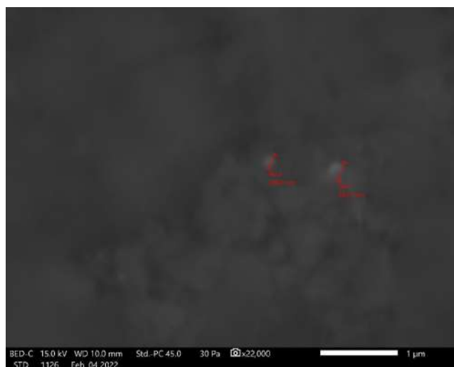
а) температура 390°C, размер частиц 206 нм и 264 нм
