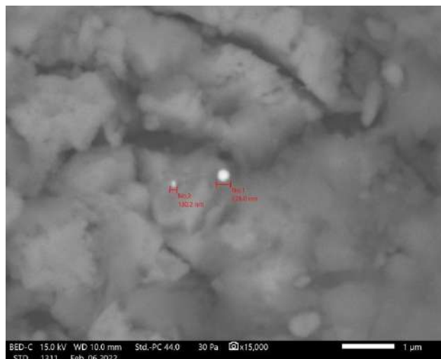
з) температура 625°C, размер наночастиц золота 130 нм и 280 нм
