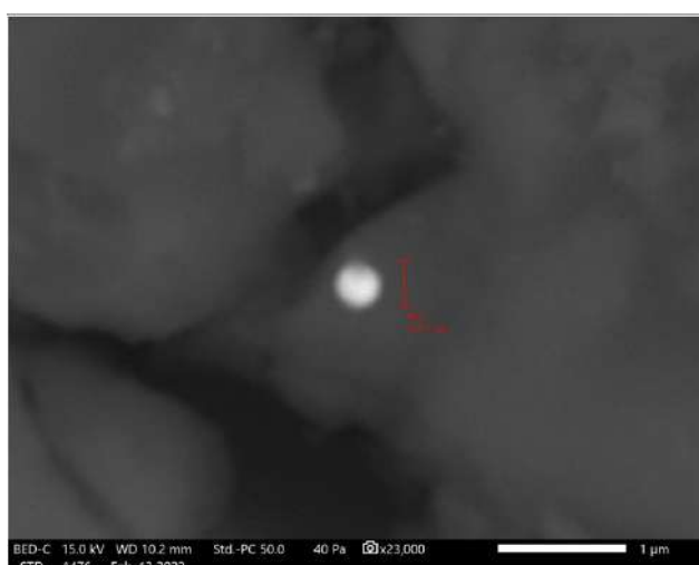
е) температура 700°C, на поверхности силикатного минерала наблюдаются наночастицы золота размером 380 нм
