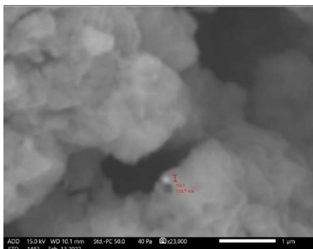
д) температура 700°C, наночастицы размером от 120 нм наблюдаются на поверхности частицы оксида железа
