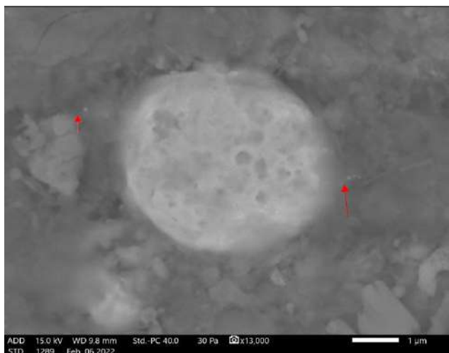
д) температура 490°C, крупные частицы золота размером около 5 микрон и более мелкие наночастицы размером от 50 до 100 нм
