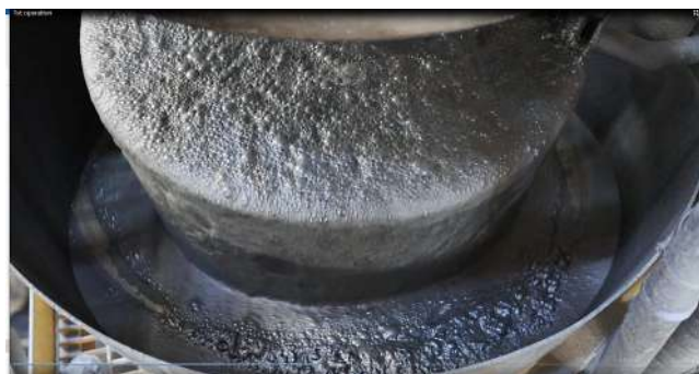
Рис. 2. Концентрат основной флотации с использованием пневматической флотомашины Jameson Cell L500
