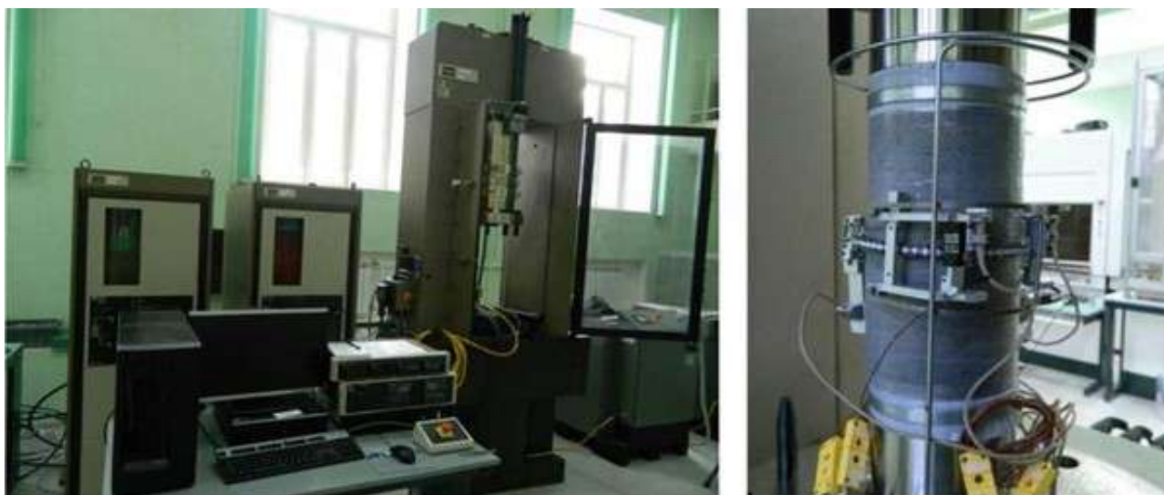
Рис. 1. Сервогидравлическая система MTS 815 (слева), подготовленный к испытаниям образец (справа)
