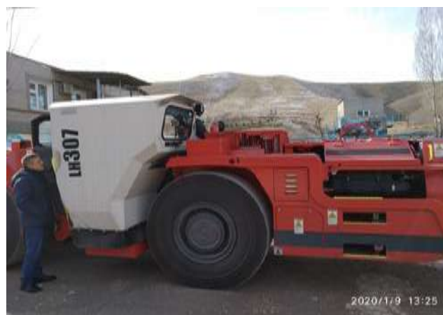
Фото. Погрузочно-доставочная машина LH-307 компании Sandvik
