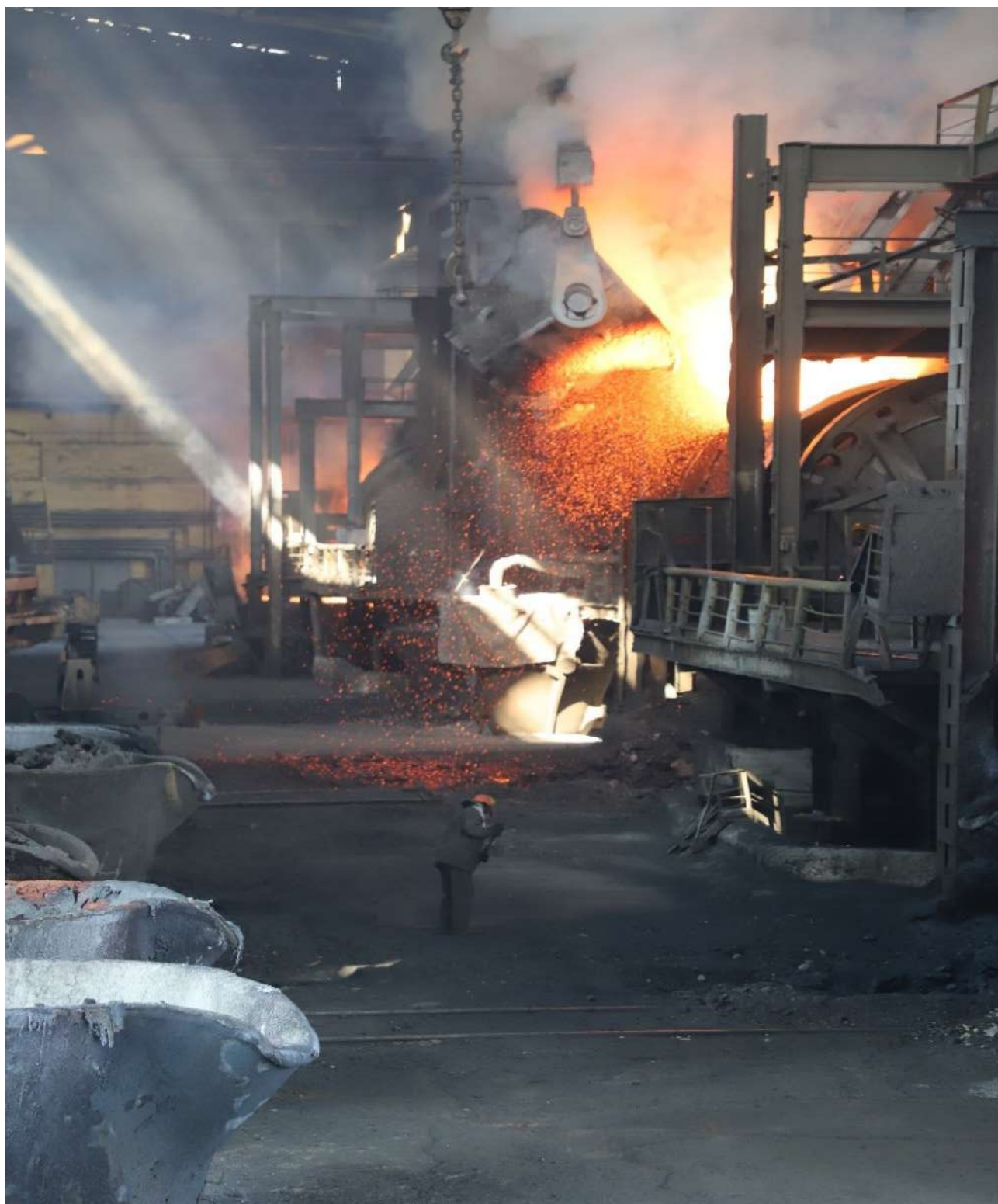
Фото. Конвертирование медных штейнов
