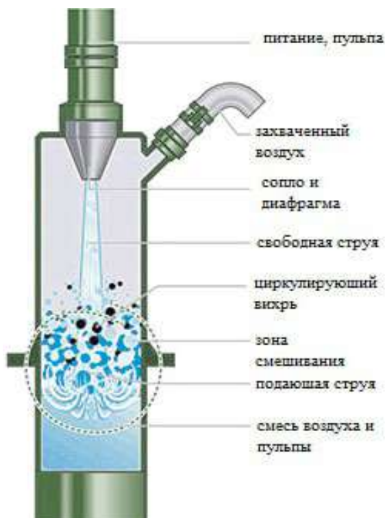
Рис. 3. Принцип работы пневматической флотомашины
