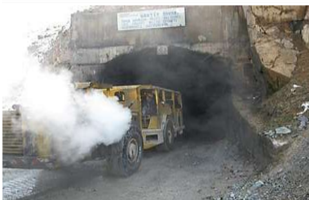
Фото. Подземная самоходная машина для перевозки людей SWT-101L доставляет работников шахты на рабочие места
