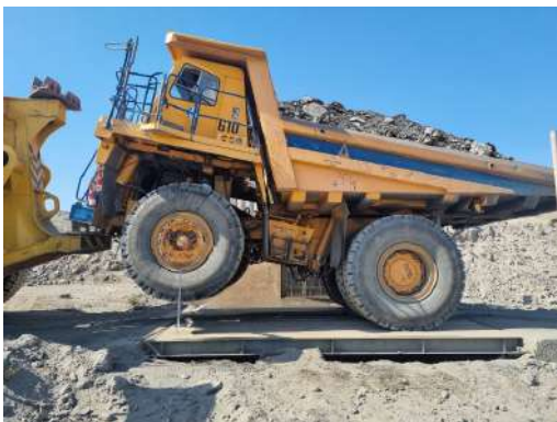
Рис. 2. Определение горизонтальной координаты x_c (а) и вертикальной координаты y_c (б)
