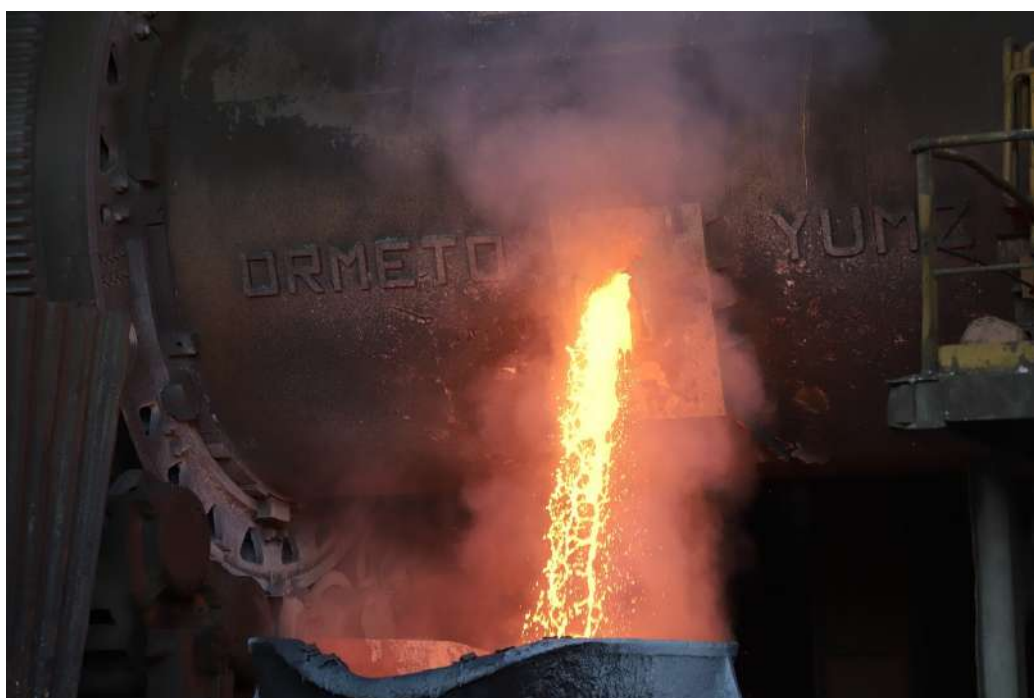
Фото. Выдача штейна с миксера печи ПЖВ
