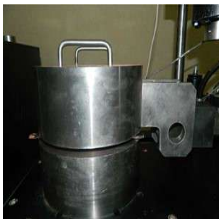
Рис. 3. Внешний вид сдвиговых матриц в сервогидравлической испытательной системе GCTS RDS-200
