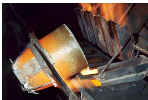
Фото. Процесс получения слитков золота и серебра
