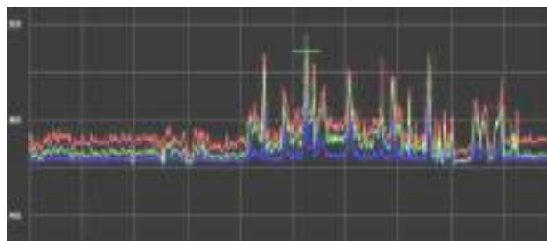
Рис. 4. Уровень виброускорения на частоте 1000 Hz при работе экскаватора в режиме погрузки горной массы в кузов автосамосвала
