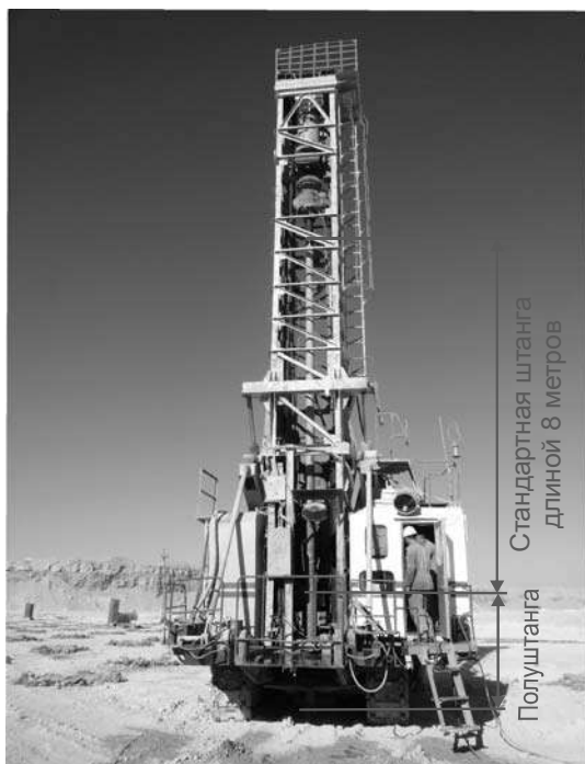
Рис. 7. Использование полуштанги на буровом станке СБШ-250МНА
