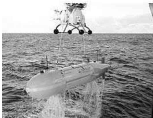
Рис. 1. Подъем подводного робота «Autosub-600»
