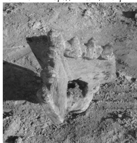
Рис. 6. Пикобур, изготовленный из отработанного шарошечного долота
