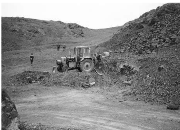
Рис. 1. Процесс добычи базальтов «Асмансайского» месторождения с помощью погрузочного трактора
