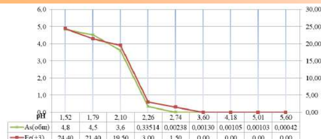
Рис.1. Динамика изменения концентрации железа и мышьяка при нейтрализации известью
