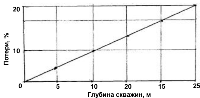
Рис. 1. График зависимости потерь неотбитой руды от глубины горизонтальных скважин
