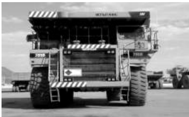
Рис. 5. Модернизированный карьерный самосвал КАТ-785В для работы на газодизельной смеси
