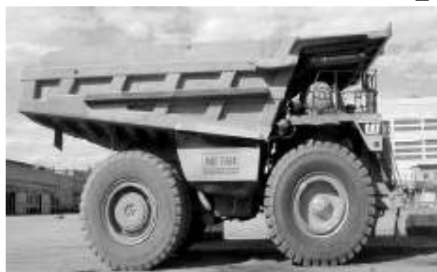
Рис. 5. Модернизированный карьерный самосвал КАТ-785В для работы на газодизельной смеси
