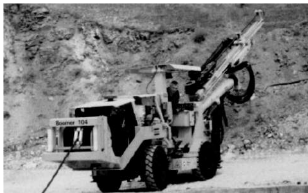
Рис. 1. Гидравлическая буровая установка Boomer 104-1238 фирмы Atlas Copco
