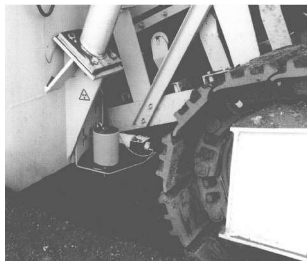
Рис. 2. Устройство распознавания границ пластов
