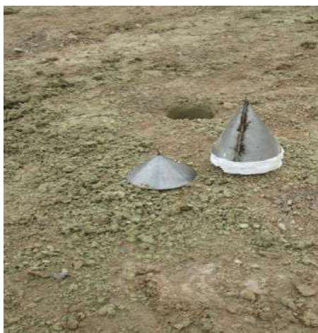
Рис. 2. Кумулятивный конус из стального материала.
