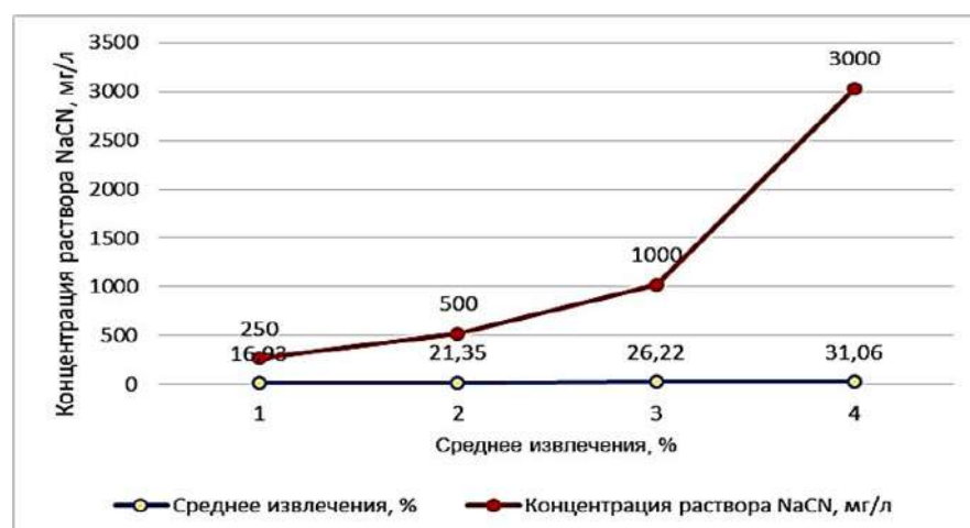
Рис. 4. Зависимость извлечения золота от концентрации NaCN измельченной до -0,074 мм 65 % пробы хвостов.
