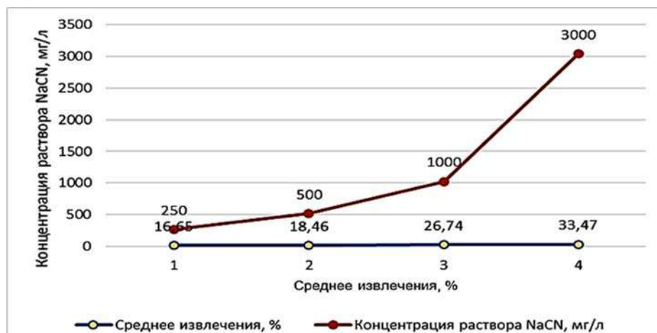
Рис. 3. Зависимость извлечения золота от концентрации NaCN измельченной до -0,074 мм 56 % пробы хвостов.
