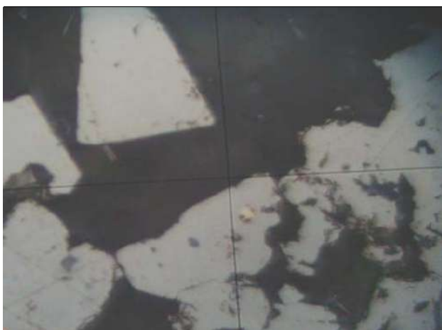
Рис. 1, б. Самородное золото в пирите. Умеренно высокопробное (809‰) золото (желтое), неправильной формы, размером 4 мкм, находятся в пористом участке пирита.
