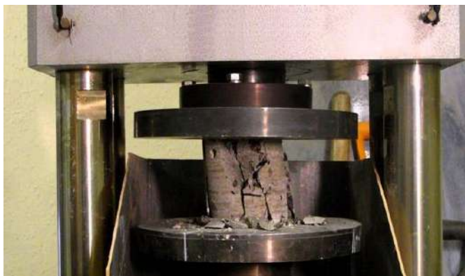
Рис. 3. Лабораторные испытания образцов на одноосное сжатие
