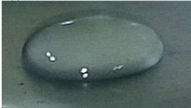
Рис.5. Поверхность обработанная супергидрофобным покрытием на основе воскоподобных смесей предельных углеводородов
