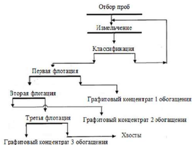
Рис 1. Принципиальная схема обогащения графитовые руды
