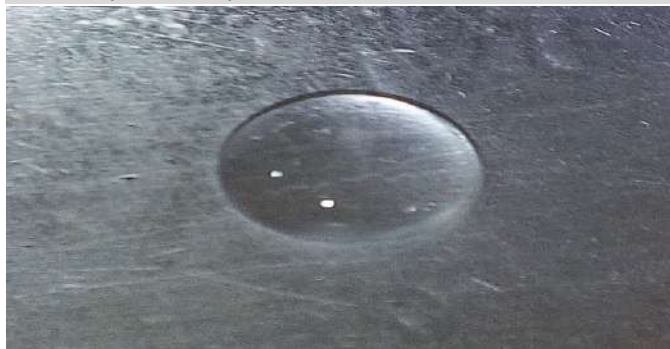
Рис.4. Поверхность обработанная супергидрофобным покрытием на основе природного силиката кадмия
