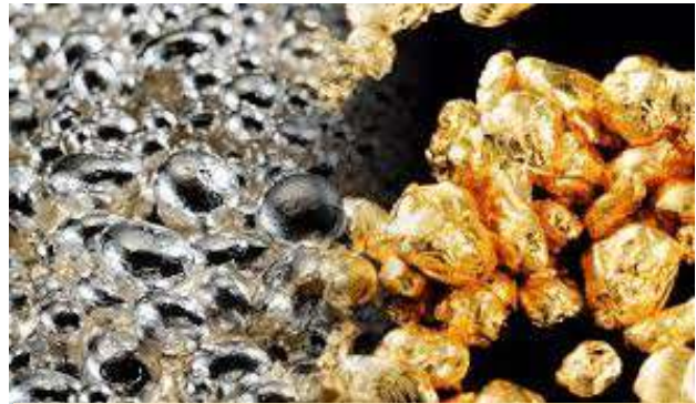
Рис.4. Амальгамация золота. Слева золотые зерна покрытые ртутью (амальгама) [13]
