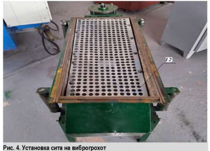
Рис. 4. Установка сита на виброгрохот
