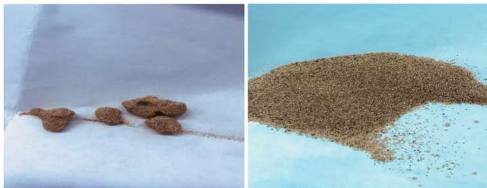
Рис.1. Общий вид мелкозернистой и обломочной части горной породы Нуратинского месторождения: а - кусочки обломочные; б - мелкозернистая часть
