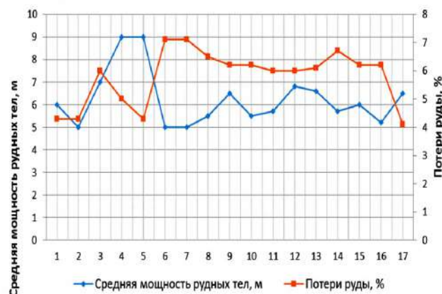
Диаграмма 2. Проектные потери руды в зависимости от средней мощности рудных тел. (Названия месторождений пронумерованы в соответствии с табл. 1)
