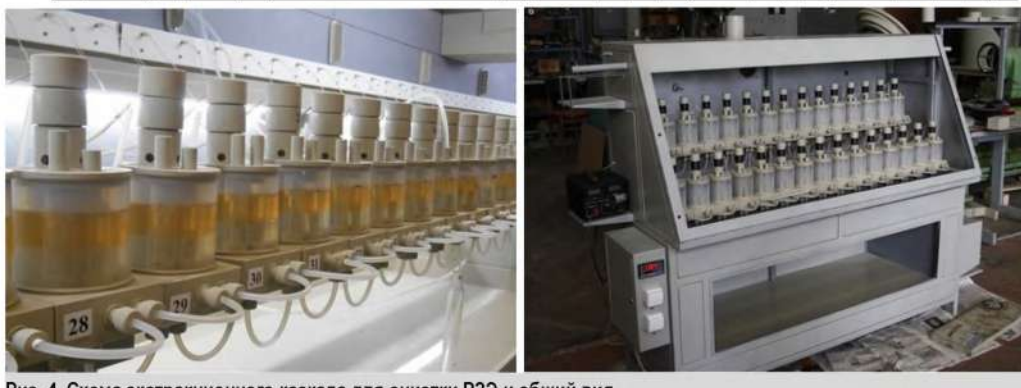
Рис. 4. Схема экстракционного каскада для очистки РЗЭ и общий вид
