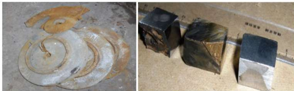
Рис. 2. а – питающие диски дробилки модели KEV 96; б - образцы, вырезанные из них
