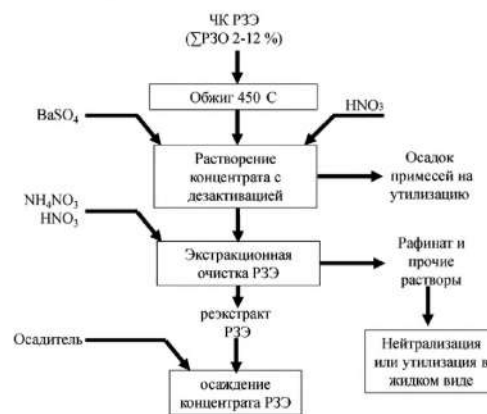
Рис. 5. Технологическая схема переработки черновых концентратов РЗЭ
